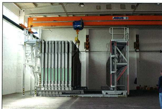
Encofrado de batería cerrado
