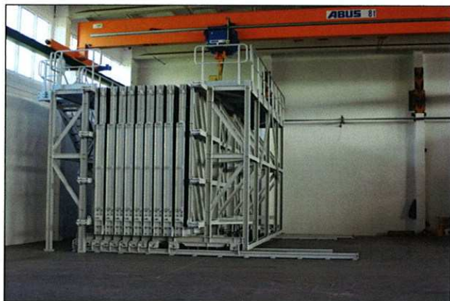
Encofrado de batería cerrado
