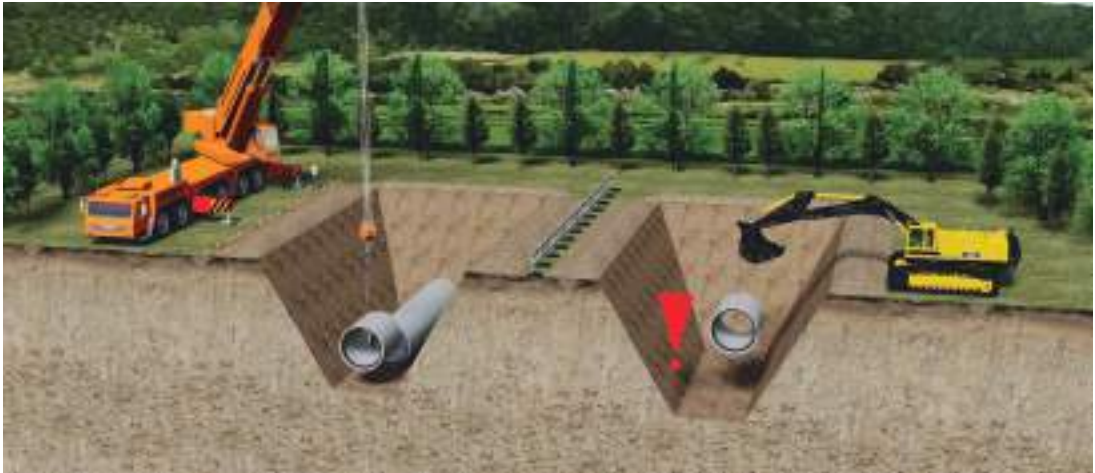
Fig. 21: Zanjas y pozos sin entibación
