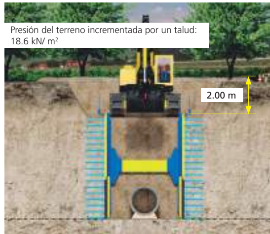
Fig. 4: Presión con talud
