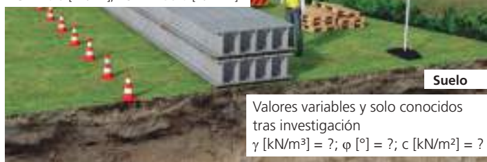
Fig. 2: comparación entre las características del acero y del suelo
