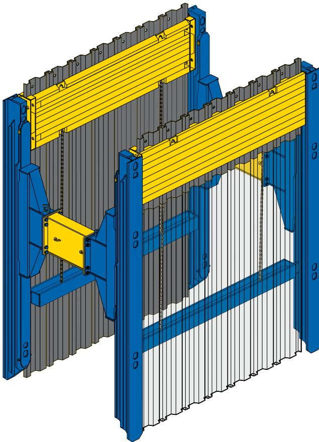
Las cámaras se insertan en los carriles exteriores de las dobles guías, cuando es necesario un zuncho colgante,
