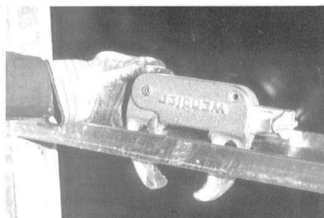
Figura 6 Cerrojo sobre un perfil de la pantalla GAMMA
